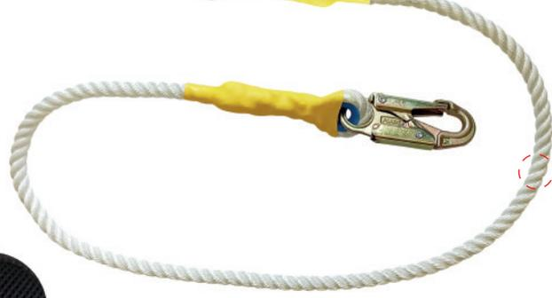
Línea de conexión, con 1 gancho de 3/4", de cabo torcido de nylon/ poliéster de 5/8" Longitud: 1,80 m
