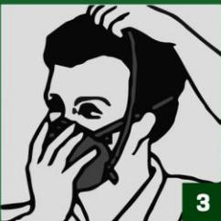
3 Coloque la banda superior en la parte superior de la cabeza posterior y la banda inferior debajo de las orejas.
